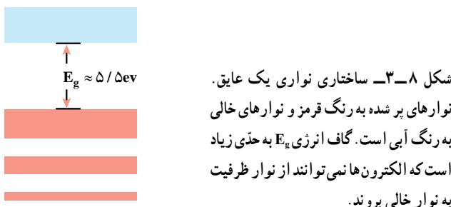
شکل ۳-۸- ساختاری نواری یک عایق.
